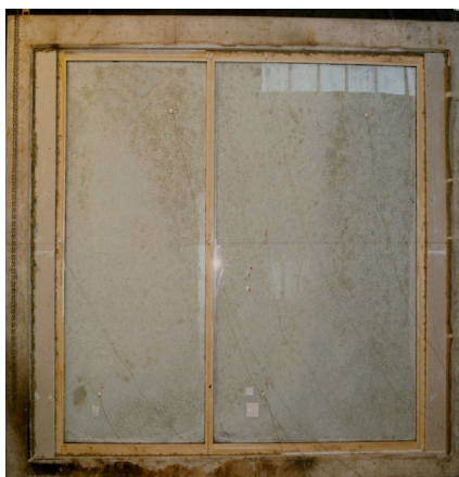
Trennwand mit Brandschutzfunktion EI 30 der Jos. Berchtold AG (gegen Ende der Brandversuchsdauer).
